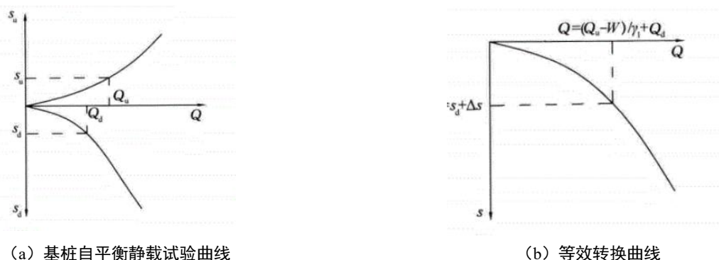
图 G.1 基桩自平衡静载试验结果转换示意
