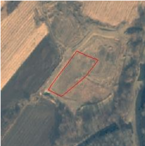
图20 弃渣(土)场清理后解译示例
