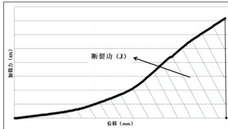
图A.3 -10℃条件下荷载-位移曲线示意图
