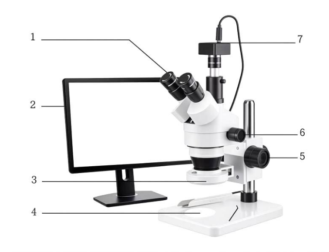
图2 图像观察式体视显微镜
